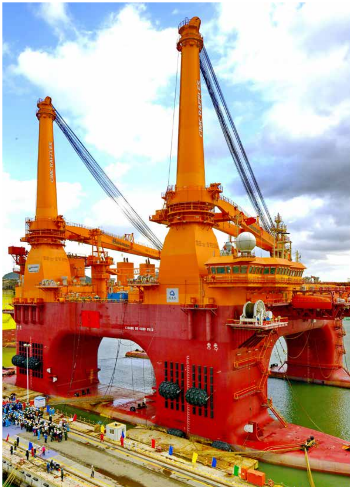
来福士交付巴西石油公司的深水半潜式起重生活平台 A semi-submersible lifting platform delivered by CIMC Raffles Co to Petrobras Co
