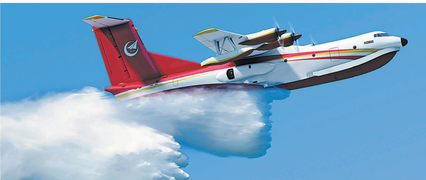
Самолет-амфибия AG600 демонстрирует тушение пожара с воздуха.
